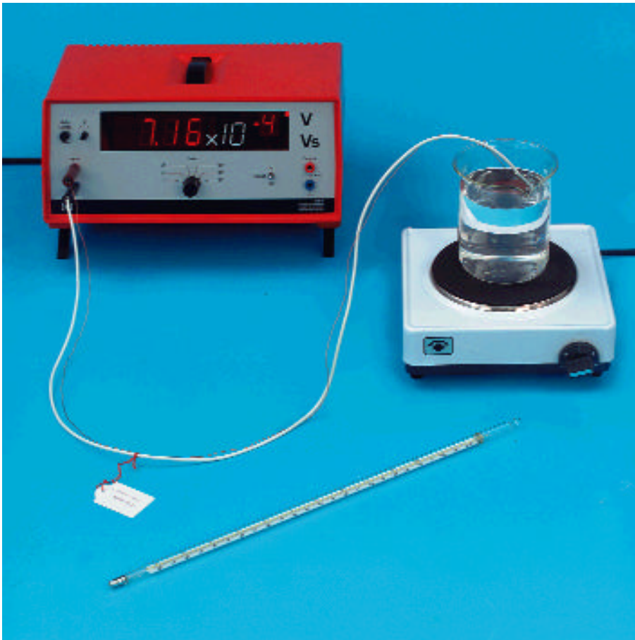
Effetto Seebeck: determinazione della tensione termoelettrica in funzione della differenza di temperatura
