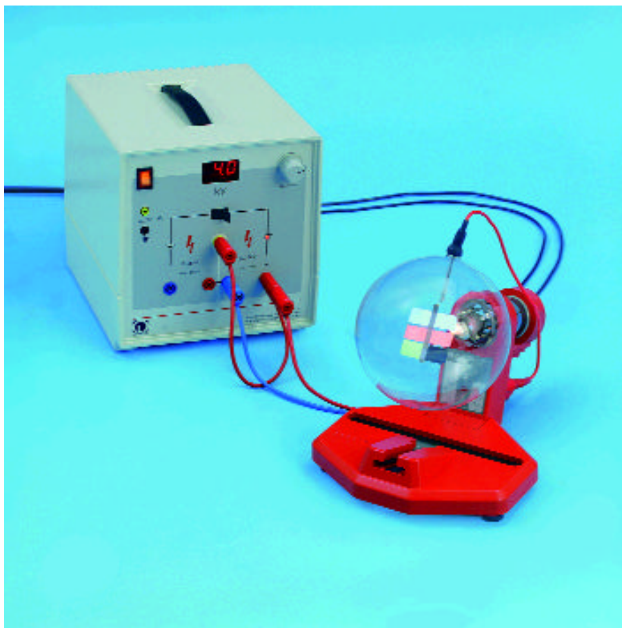
Eccitazione della luminescenza per irraggiamento con raggi ultravioletti ed elettroni
