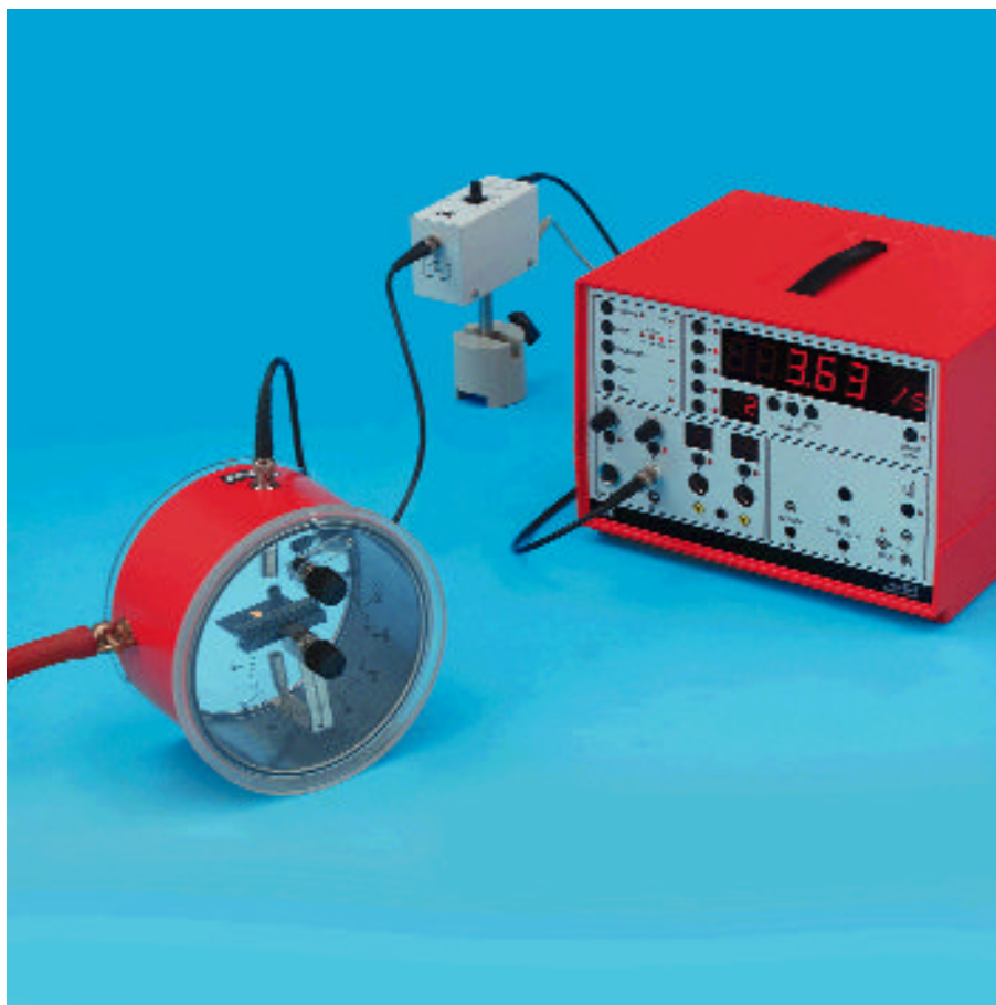
Diffusione di Rutherford: misura del tasso di diffusione in funzione dell'angolo di diffusione e del numero atomico
