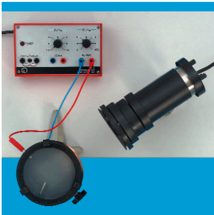
Rivelazione di tracce di particelle con la camera a nebbia di Wilson
