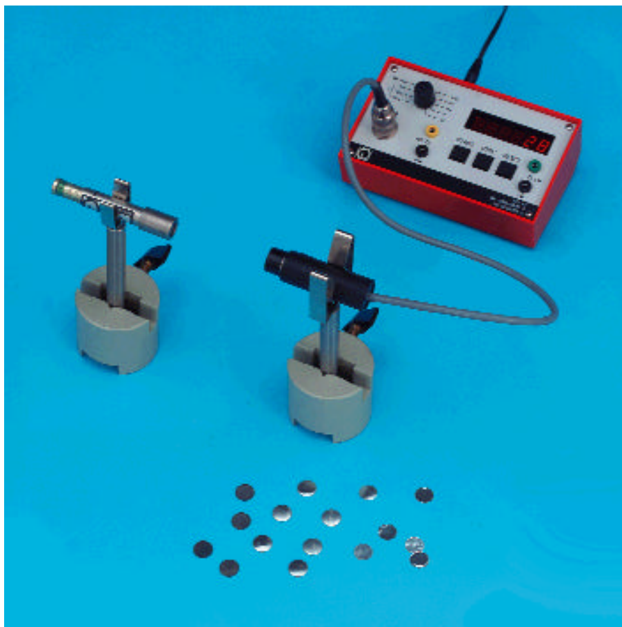
Attenuazione della radiazione H attraverso un materiale
