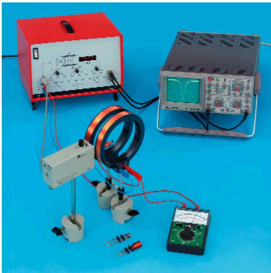
Risonanza di spin dell'elettrone nel DPPH - determinazione del campo magnetico in funzione della frequenza di risonanza
