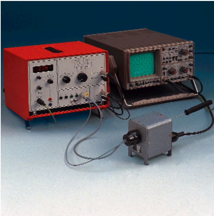
Esperimento di Franck-Hertz con il mercurio - registrazione con l'oscilloscopio
