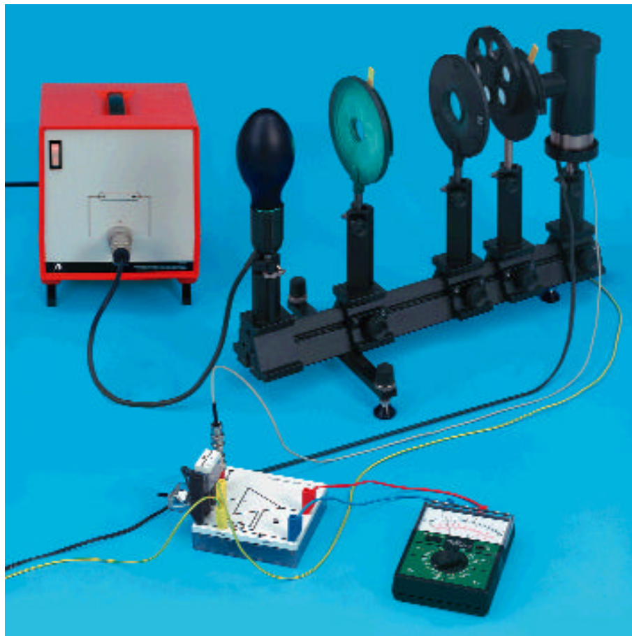
Determinazione della costante di Planck - selezione delle lunghezze d'onda con filtri ad interferenza su banco ottico
