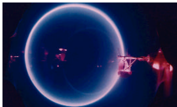
Orbita circolare dell'elettrone nel tubo a fascio sottile
