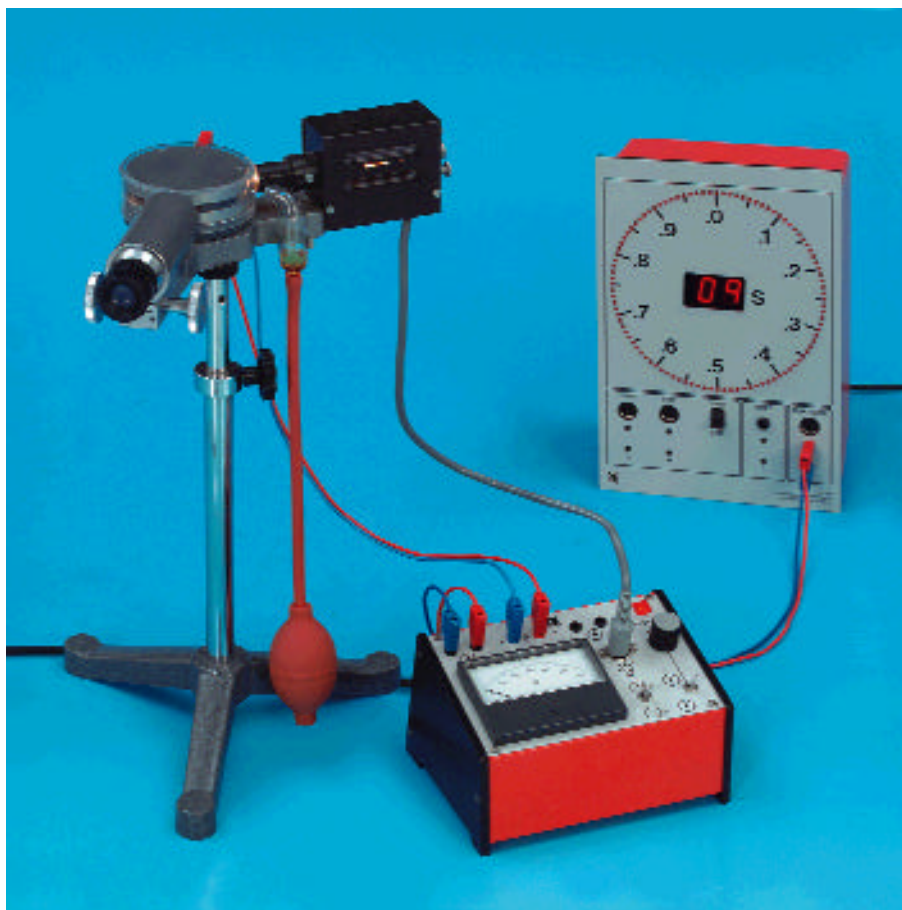
Determinazione della carica dell'elettrone con il metodo di Millikan e dimostrazione della natura quantica della carica elettrica - misura della velocità di salita e della velocità di discesa
