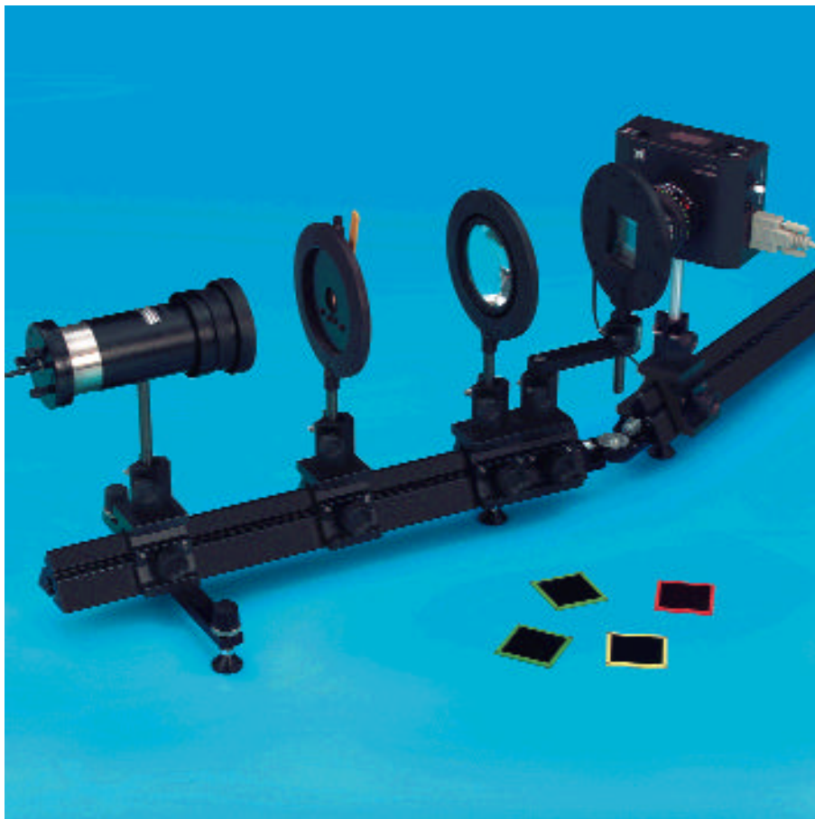
Impiego dello spettrometro a reticolo per la misura delle curve di trasmissione
