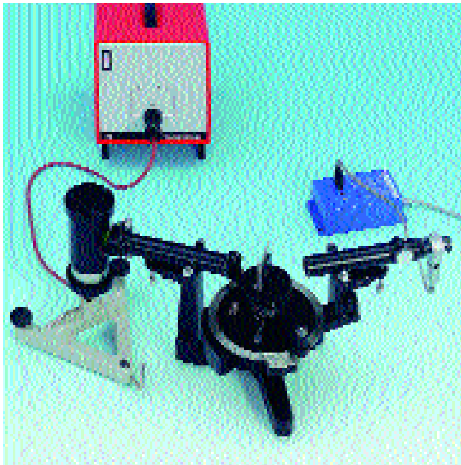
Misura delle righe dello spettro dei gas inerti e dei vapori metallici con lo spettrometro a reticolo
