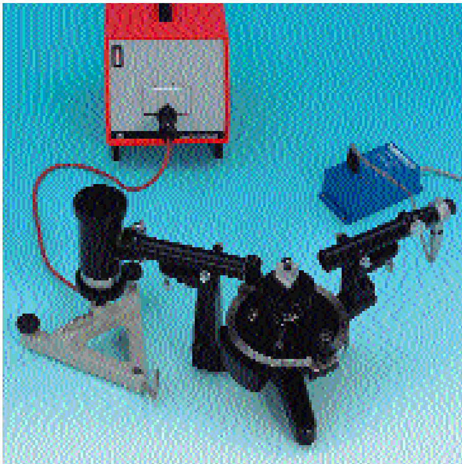
Misura delle righe dello spettro dei gas inerti e dei vapori metallici con lo spettrometro a prisma
