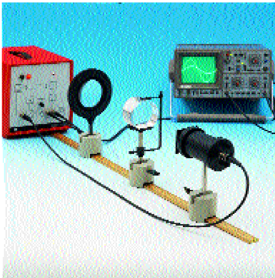
Determinazione della velocità della luce con un segnale modulato elettronicamente e con piccole distanze
