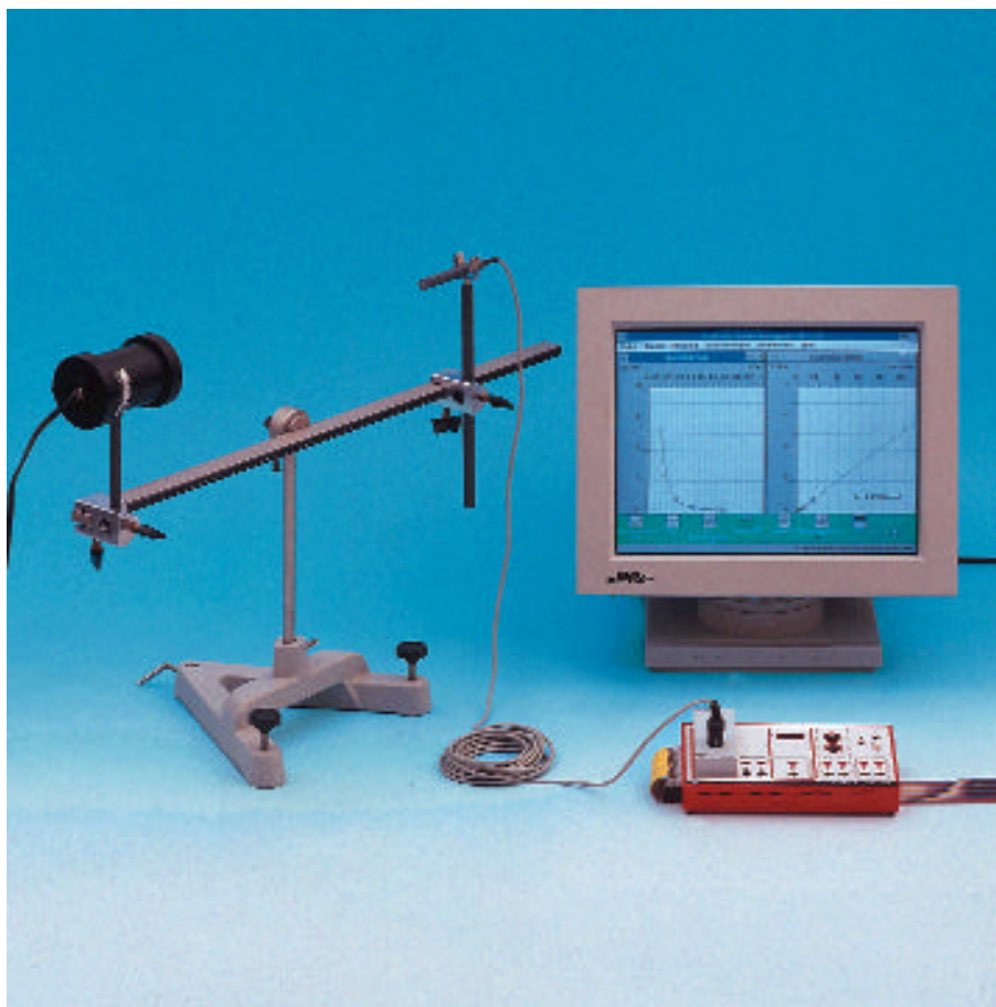
Determinazione della densità del flusso di radiazione e dell'intensità luminosa di una lampada alogena
