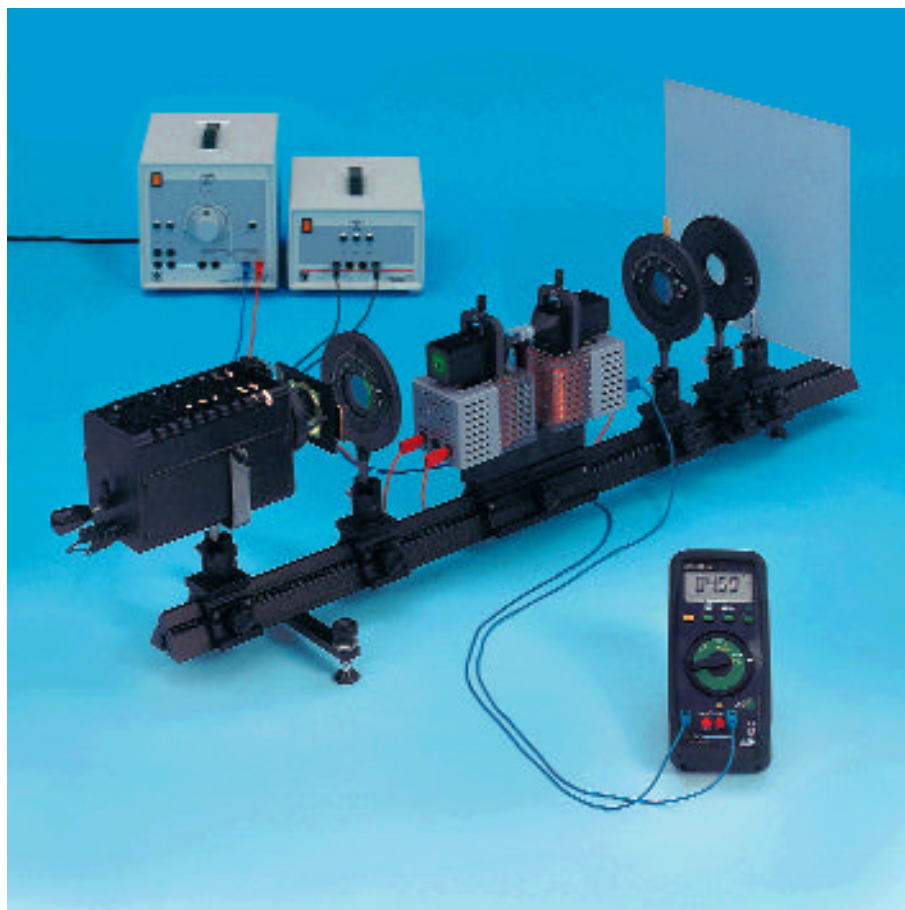
Effetto Faraday: determinazione della costante di Verdet di un cristallo in funzione della lunghezza d'onda
