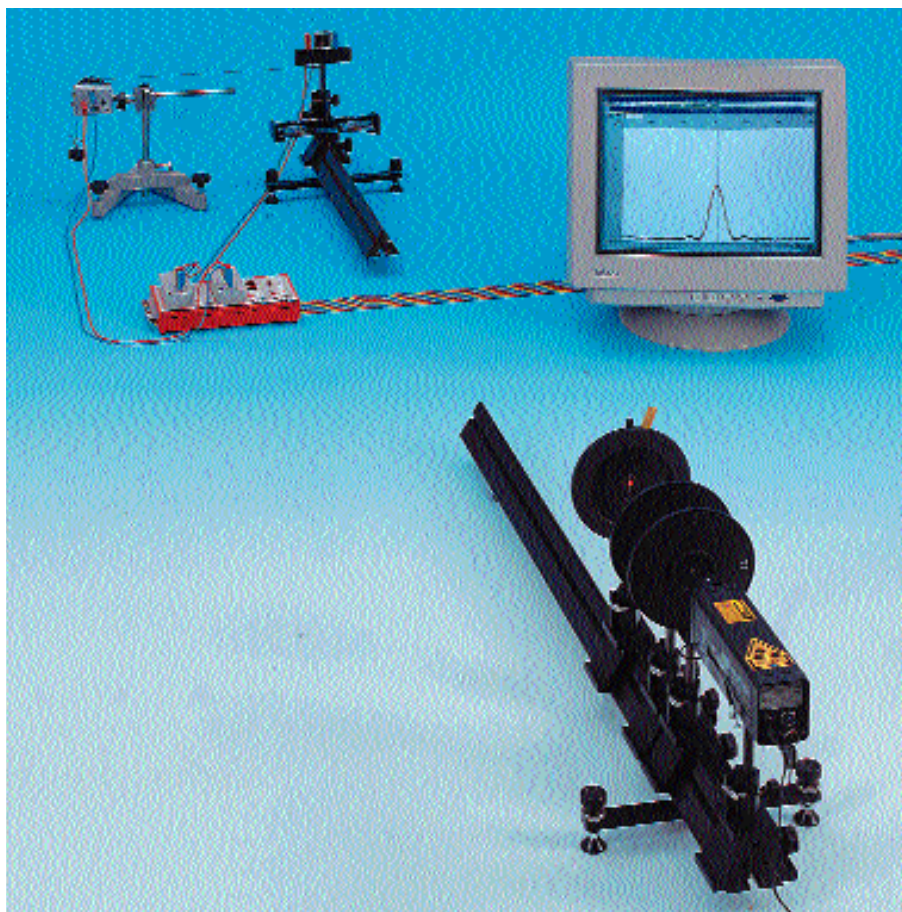
Diffrazione su una sola fenditura - misure e valutazioni con il software Acquisizione Dati Universale
