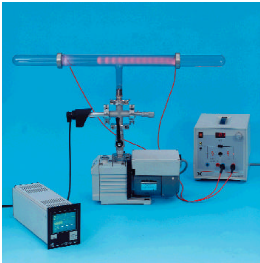
Automantenimento della scarica nell'aria in funzione della pressione
