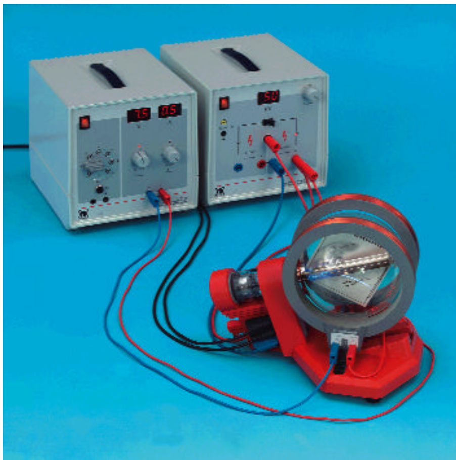
Deflessione degli elettroni in presenza di un campo elettrico e di un campo magnetico
