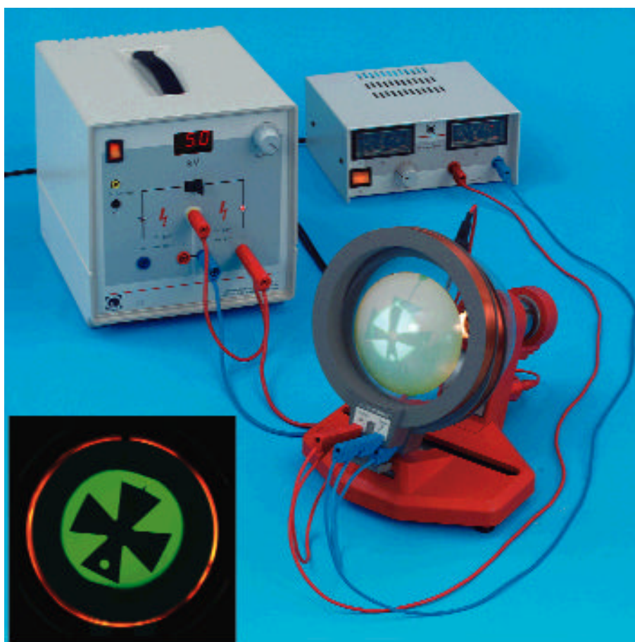
Deflessione degli elettroni in presenza di un campo magnetico assiale
