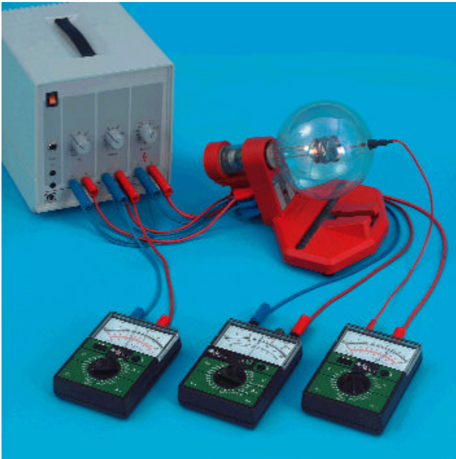
Determinazione della caratteristica di un triodo a vuoto
