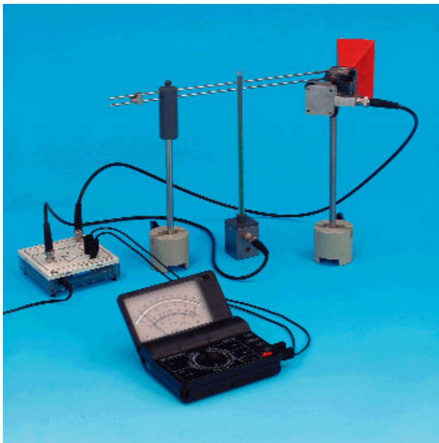
Propagazione guidata delle microonde su una linea di Lecher
