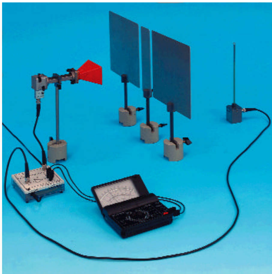
Diffrazione delle microonde su una doppia fessura
