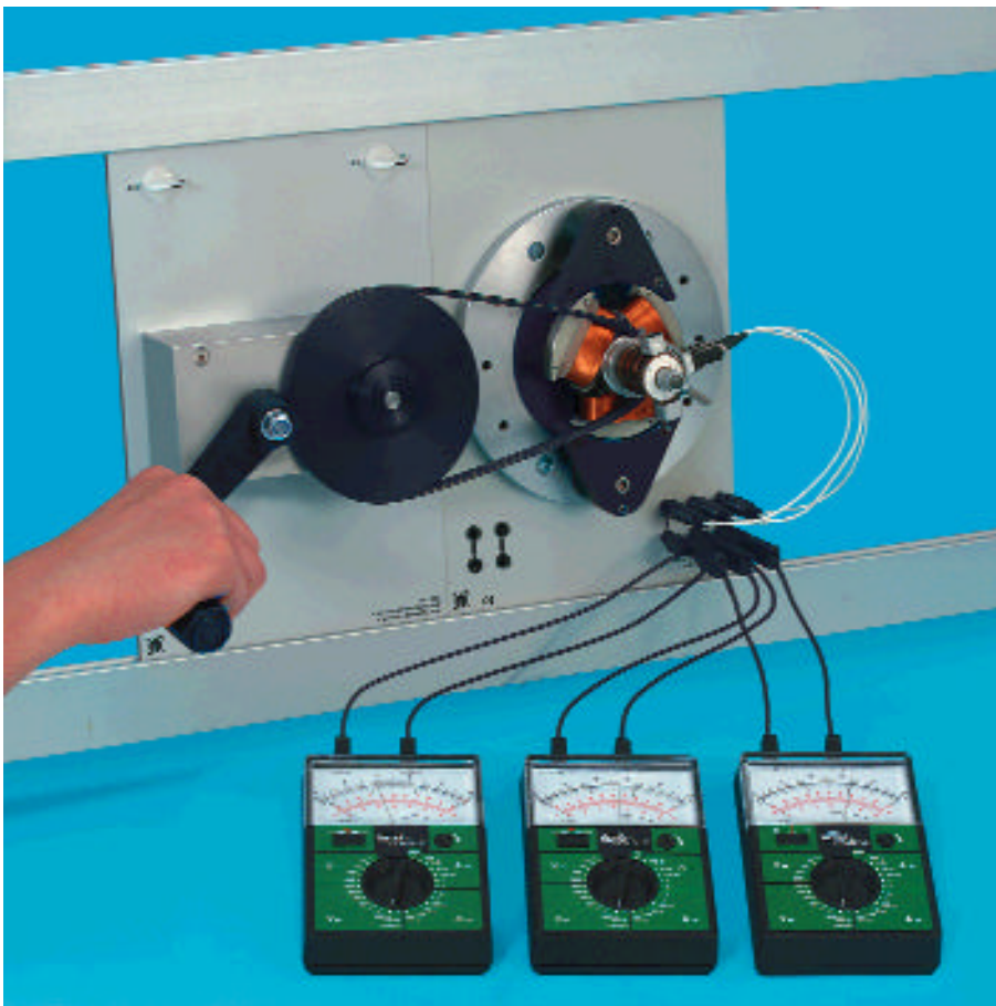
Generatore trifase con eccitazione sullo statore
