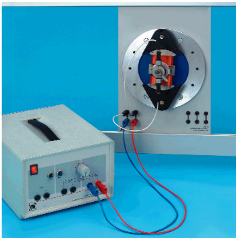
Motore DC con rotore a due poli
