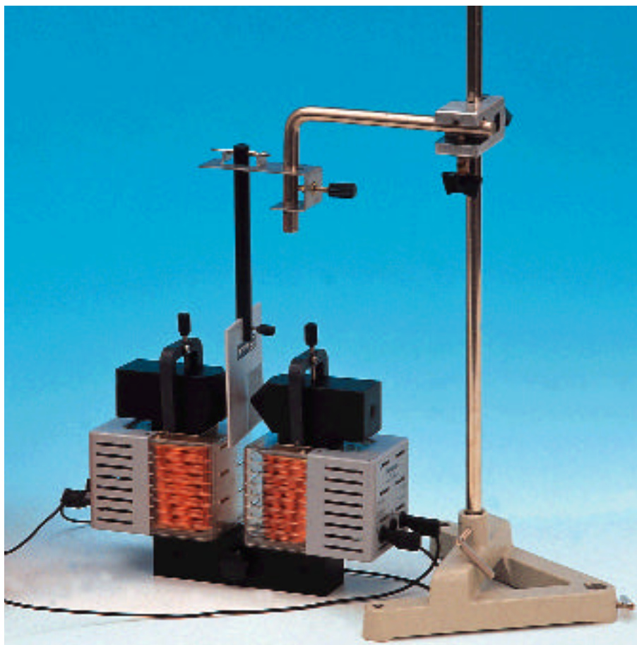
Pendolo di Waltenhofen: effetto frenante delle correnti parassite
