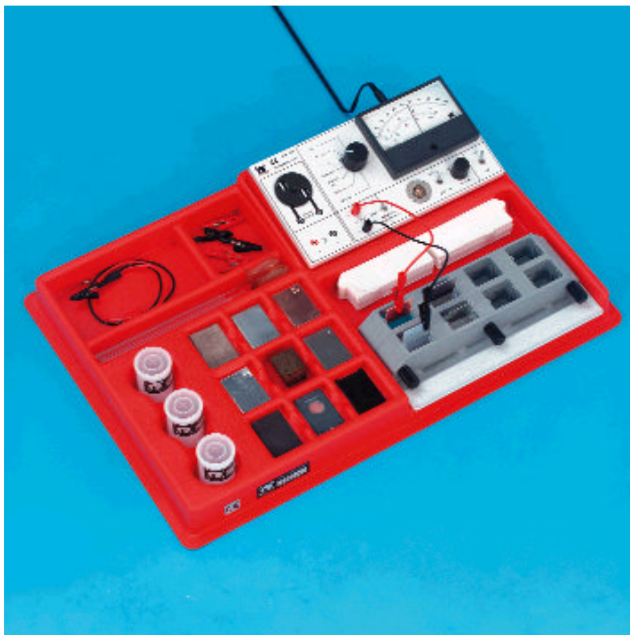
Misura della tensione su un elemento galvanico
