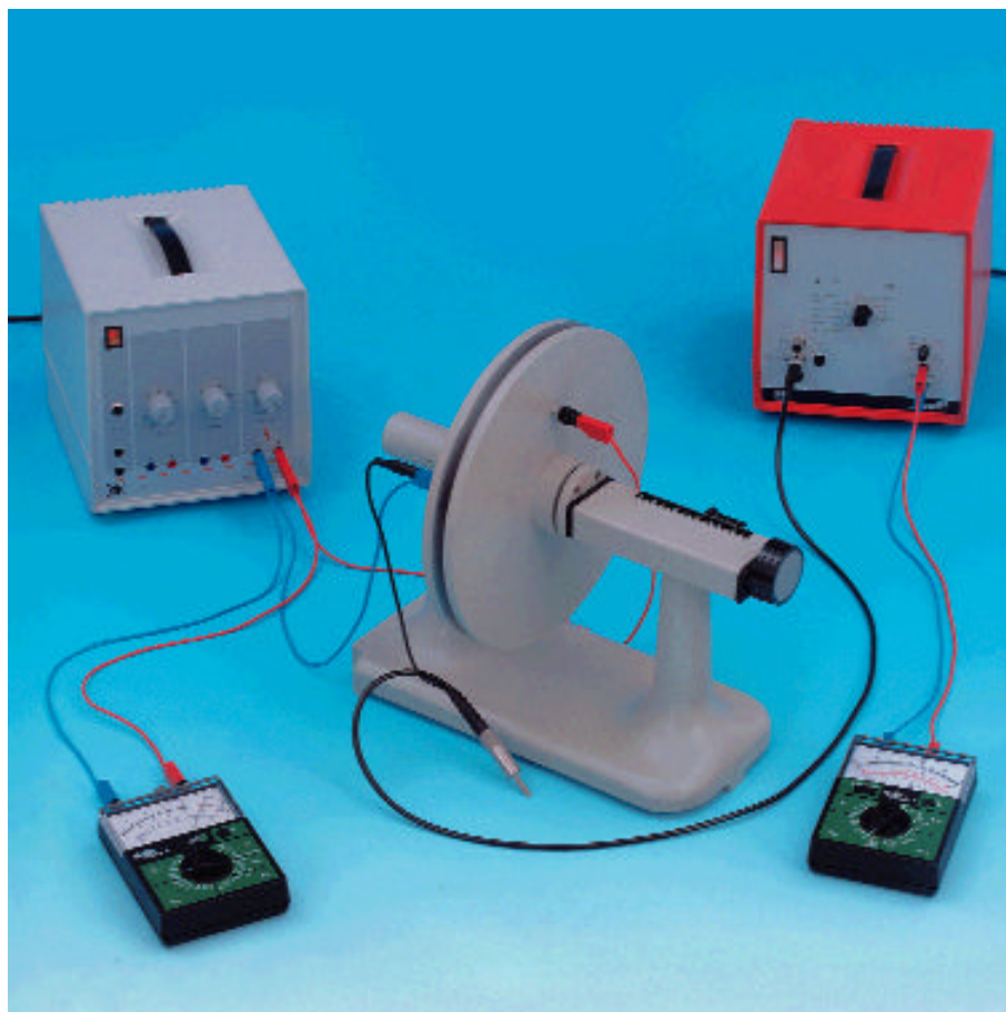
Determinazione della capacità di un condensatore ad armature parallele - misura della carica con l'amplificatore D per misure di I
