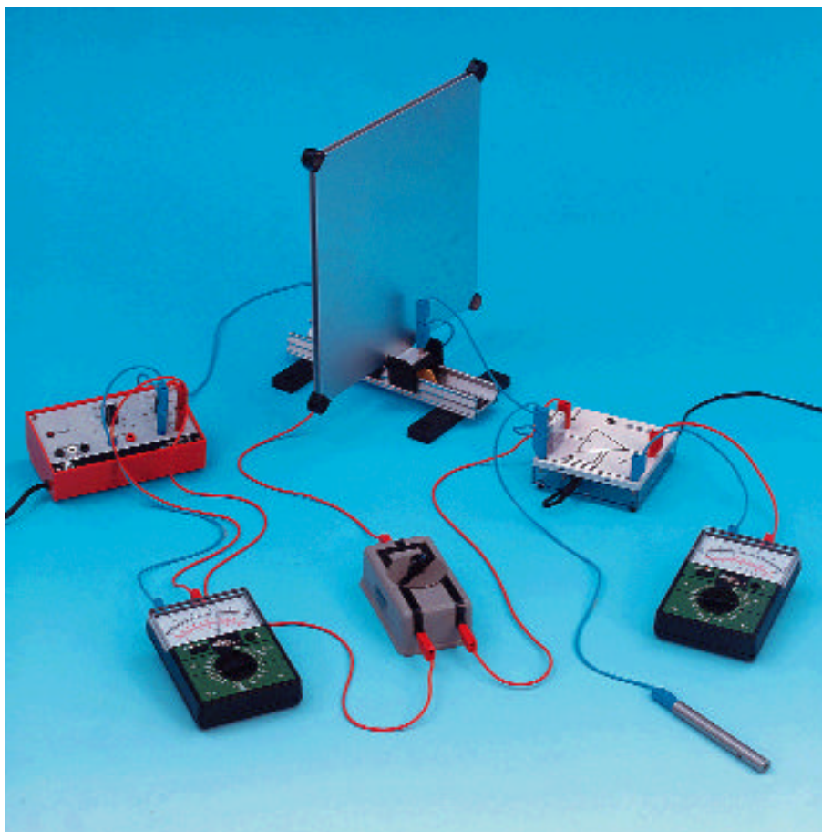
Determinazione della capacità di un condensatore piano - misura della carica con l'amplificatore elettrometrico
