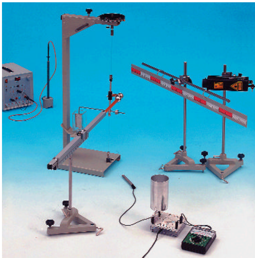
Verifica della legge di Coulomb - misura con la bilancia di torsione di Schürholz
