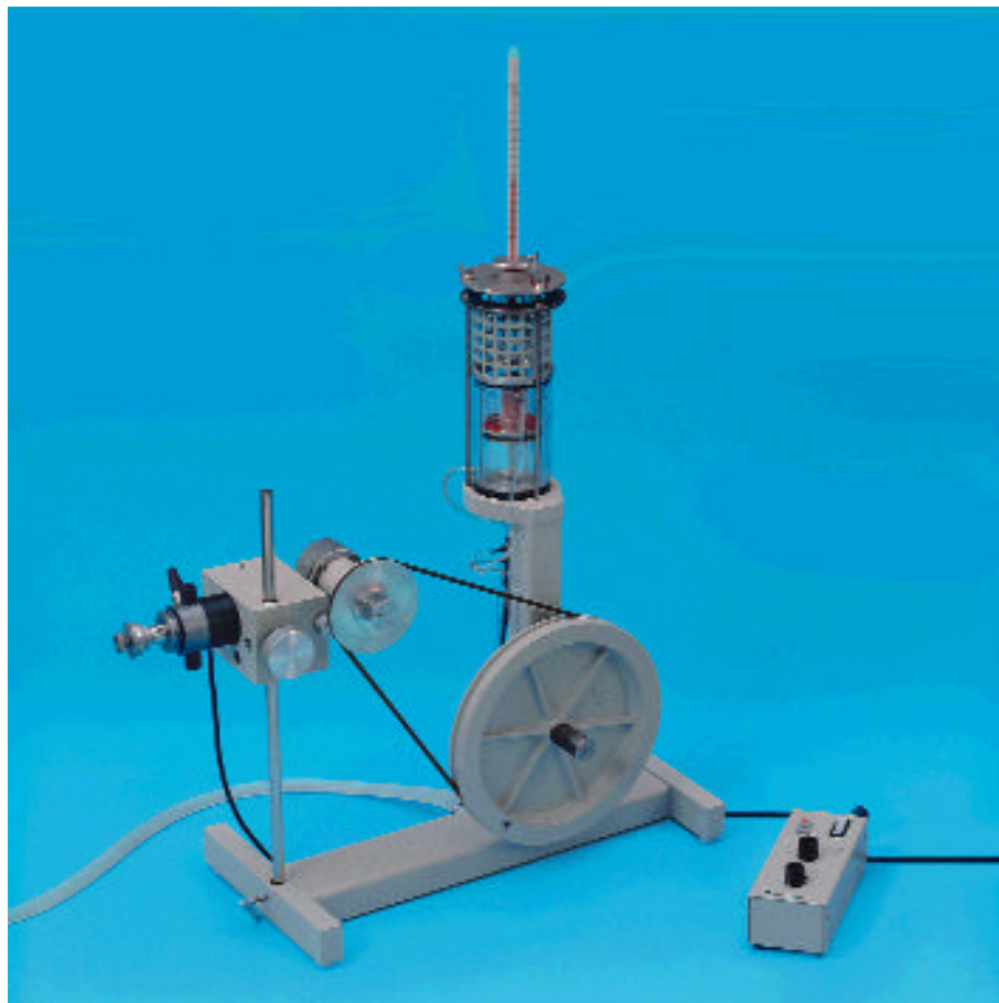
Funzionamento del motore ad aria calda come pompa di calore e come macchina refrigerante
