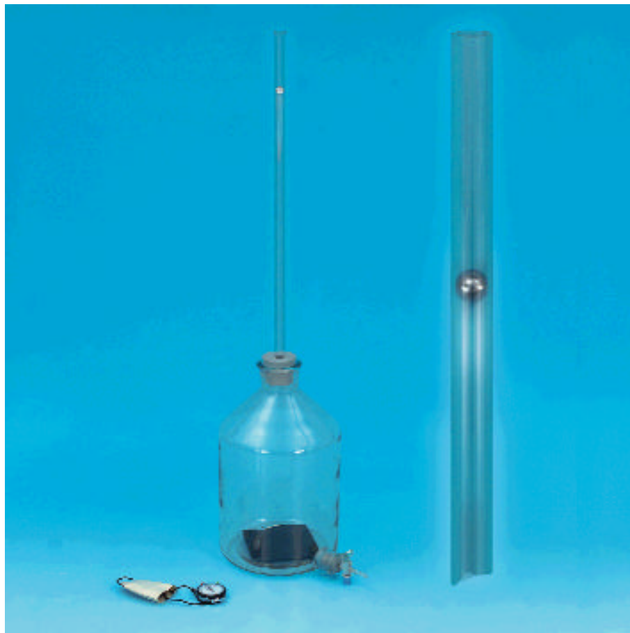
Determinazione del coefficiente adiabatico C_p/C_V dell'aria secondo Rüchard
