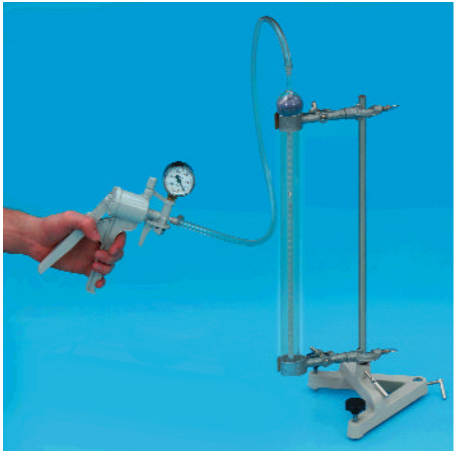
Legame tra pressione e volume in un gas a temperatura costante (legge di Boyle e Mariotte)
