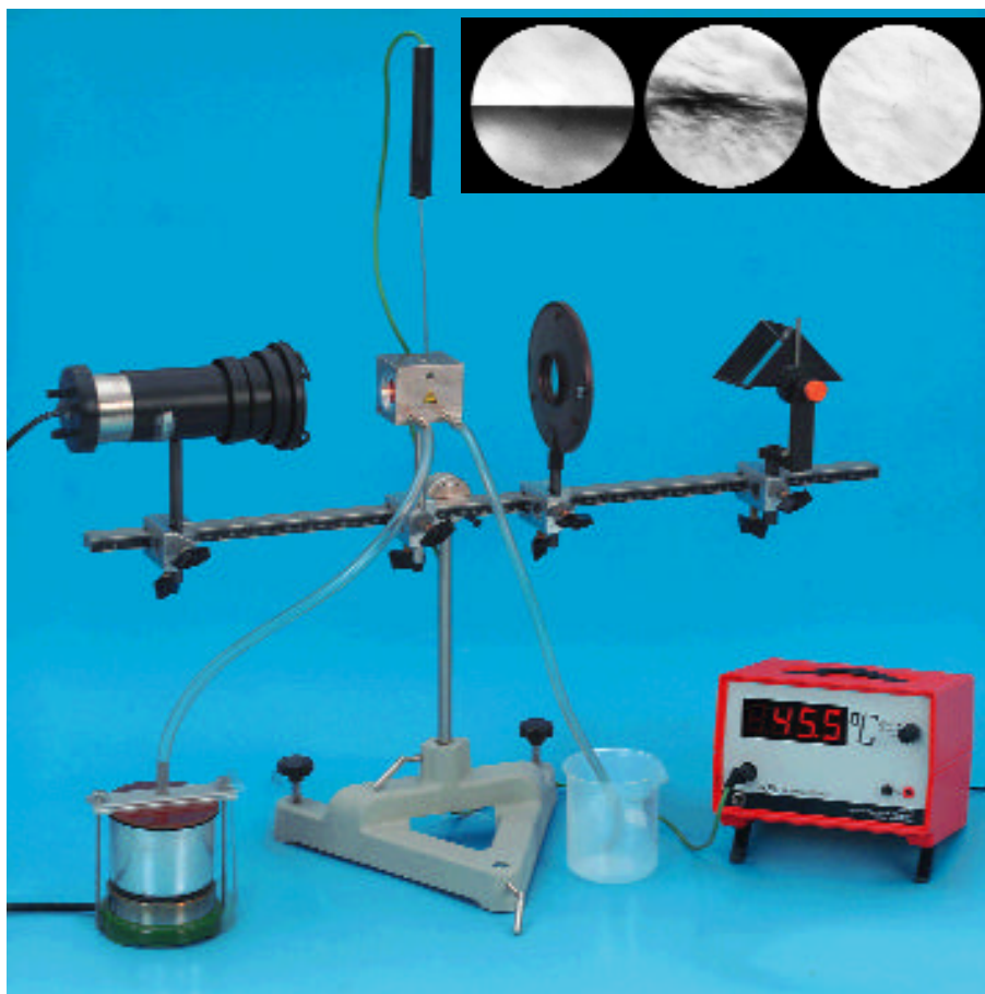
Comportamento della miscela liquido-vapore in corrispondenza del punto critico
