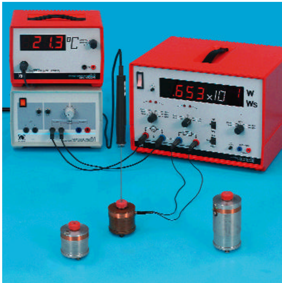
Trasformazione dell'energia elettrica in energia termica - misura eseguita con il misuratore di energia e di potenza
