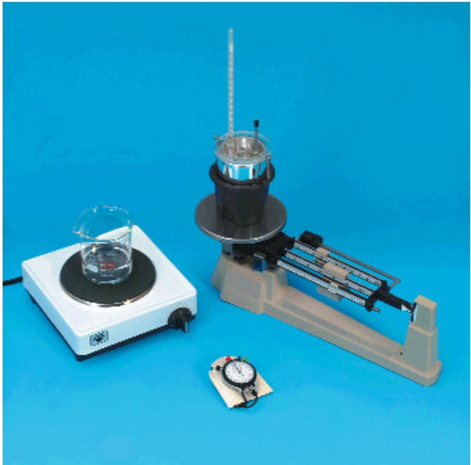
Misura della temperatura in una miscela d'acqua calda e d'acqua fredda
