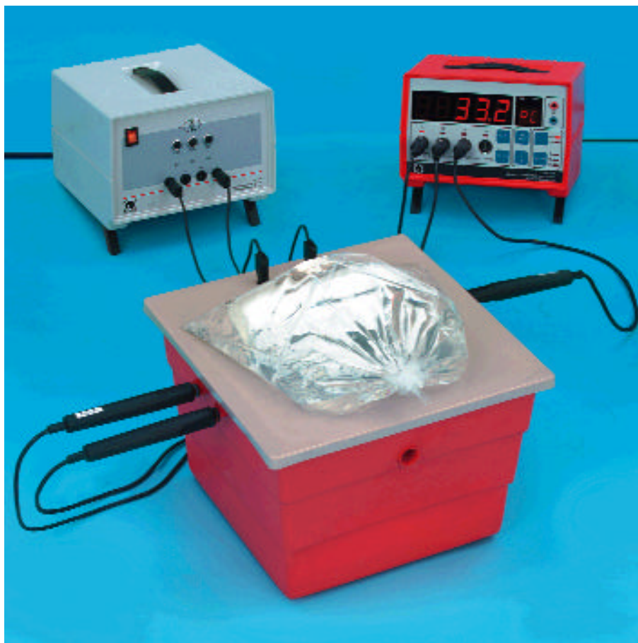
Determinazione della conducibilità termica dei materiali da costruzione utilizzando, come riferimento, un materiale di cui si conosce la conducibilità termica
