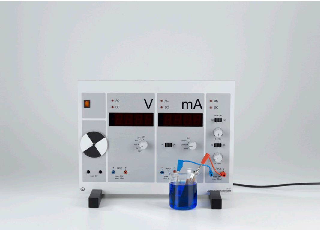
Galvanisation of a metal (C4.4.6.1)
