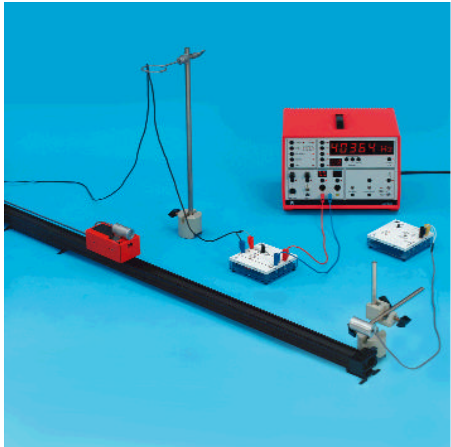
Analisi dell'effetto Doppler con onde ad ultrasuoni
