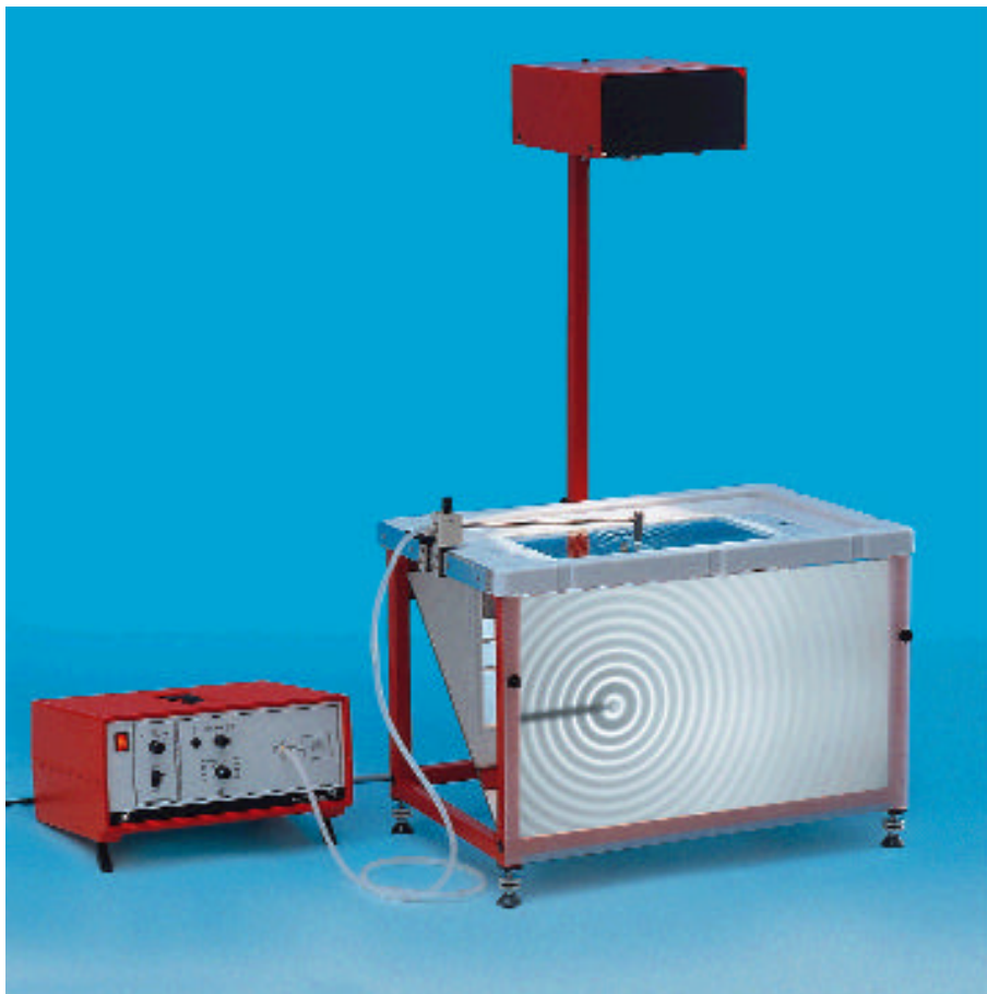
Generazione di onde circolari e piane su una superficie d'acqua
