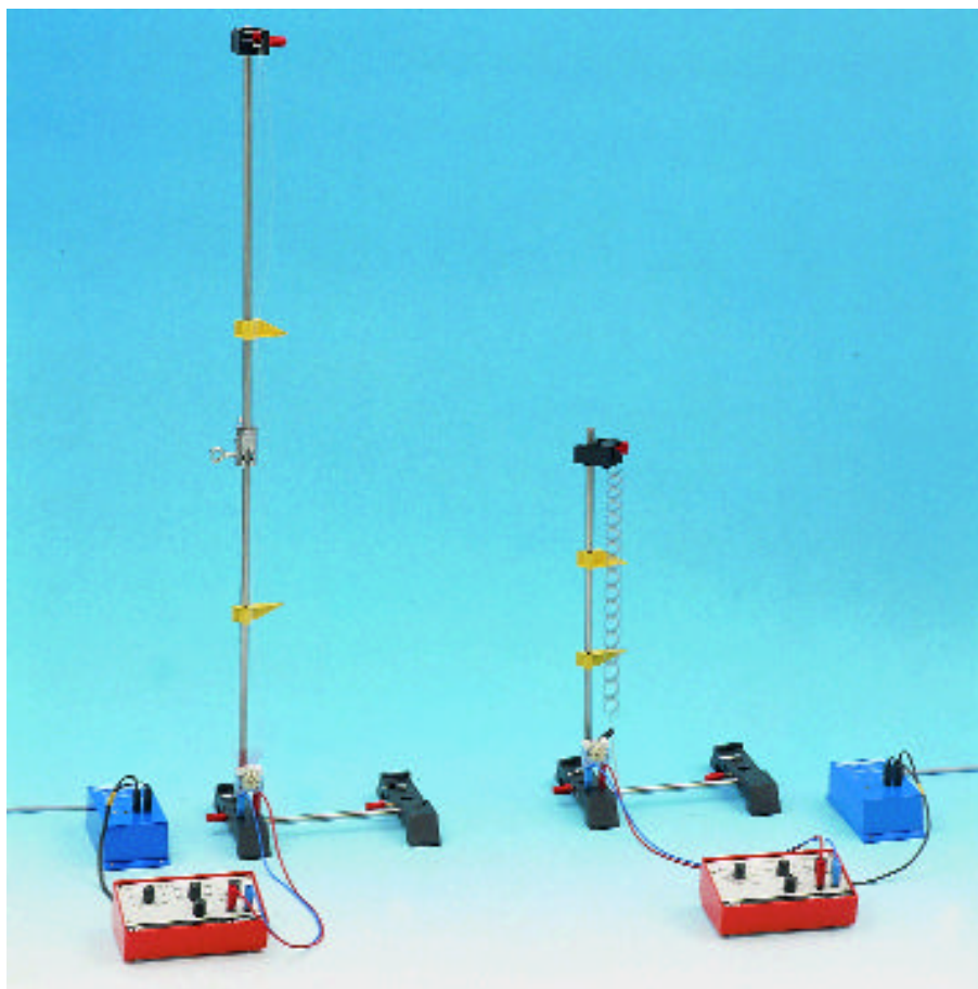
Onde stazionarie trasversali su una corda - onde stazionarie longitudinali su una molla elicoidale
