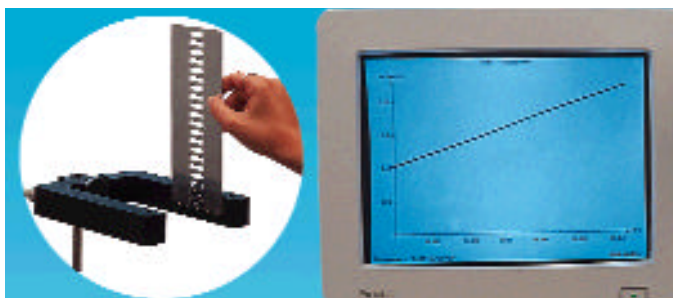
Caduta libera: misure successive del tempo con la scala-g
