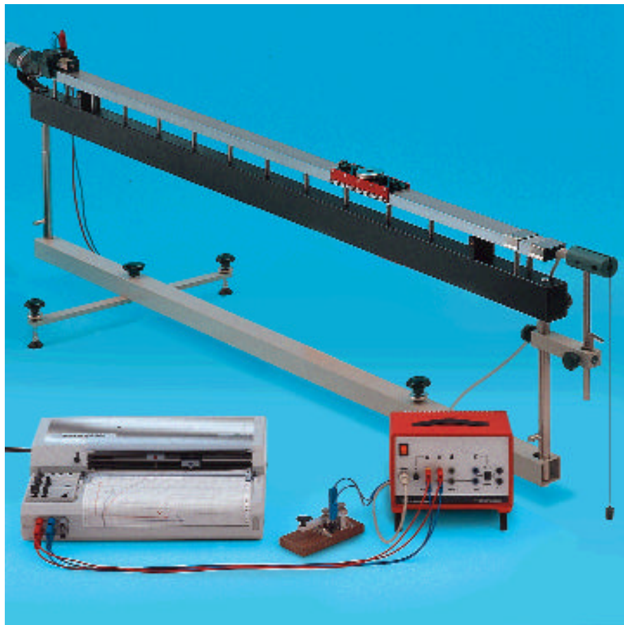
Registrazione del diagramma spazio-tempo del moto rettilineo - misura del tempo con trasduttore per la registrazione del moto e registratore Yt
