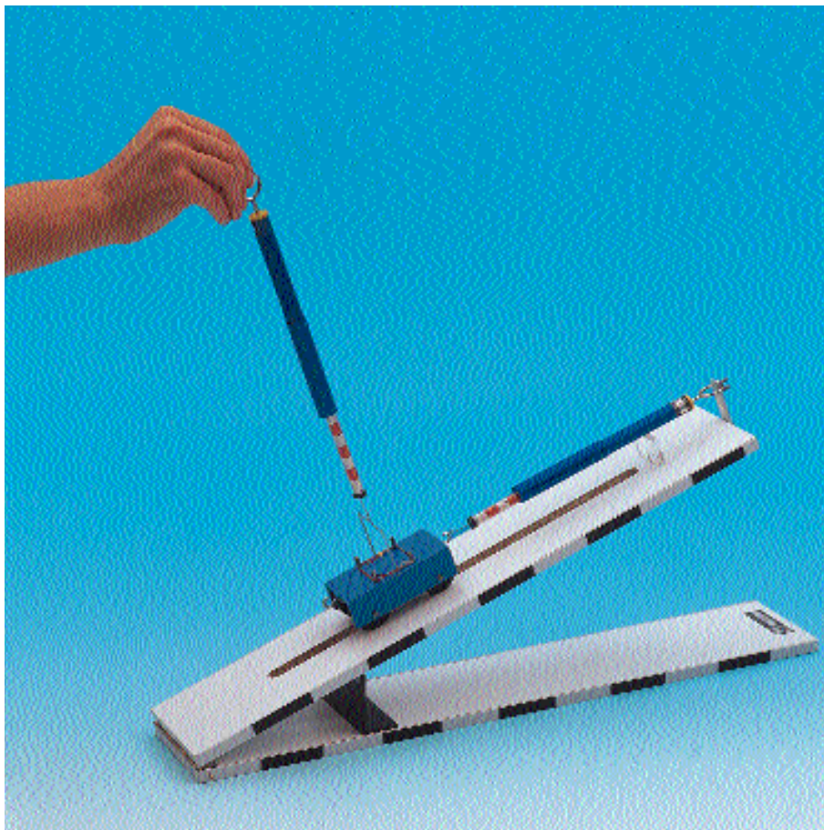
Piano inclinato: forza parallela e forza perpendicolare al piano
