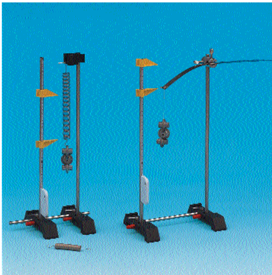
Verifica della legge di Hooke mediante una molla elicoidale e curvatura di una lamina elastica
